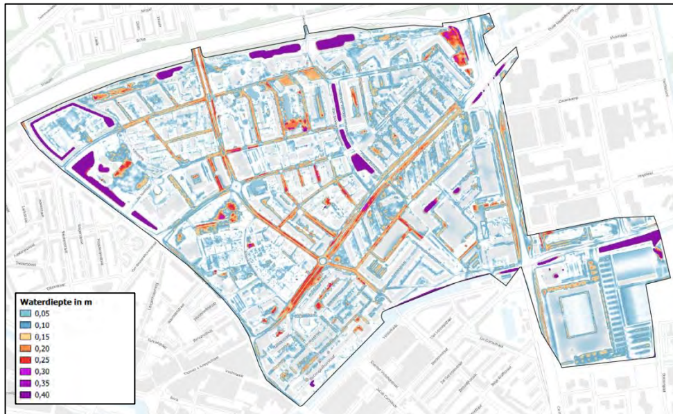
Wateroverlast bij een 70mm/u bui (huidige situatie (links) vs. wijkgerichte aanpak (rechts))
