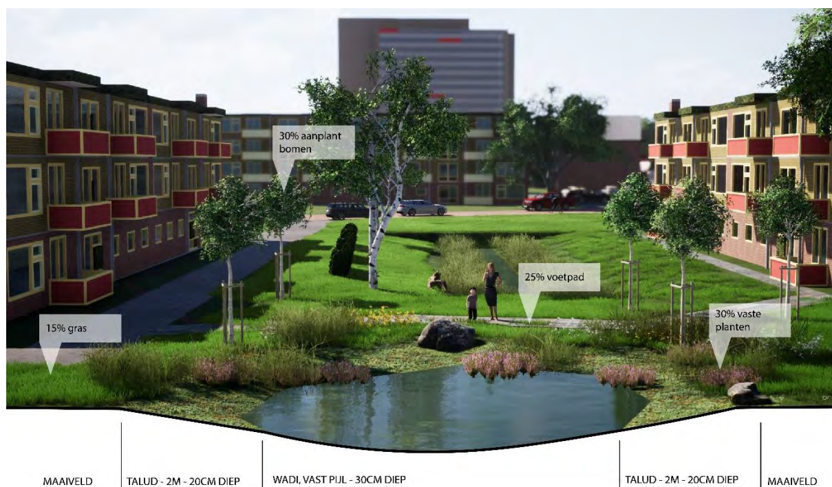
Figuur 17 Doorsnede en impressie van de aankleding van de wadi
